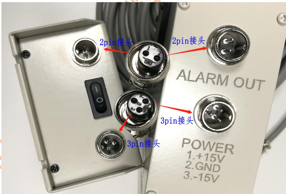
检测头、电源适配器、专用适配线对接示意图
